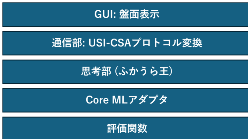
図 2. ソフトウェアの構造
